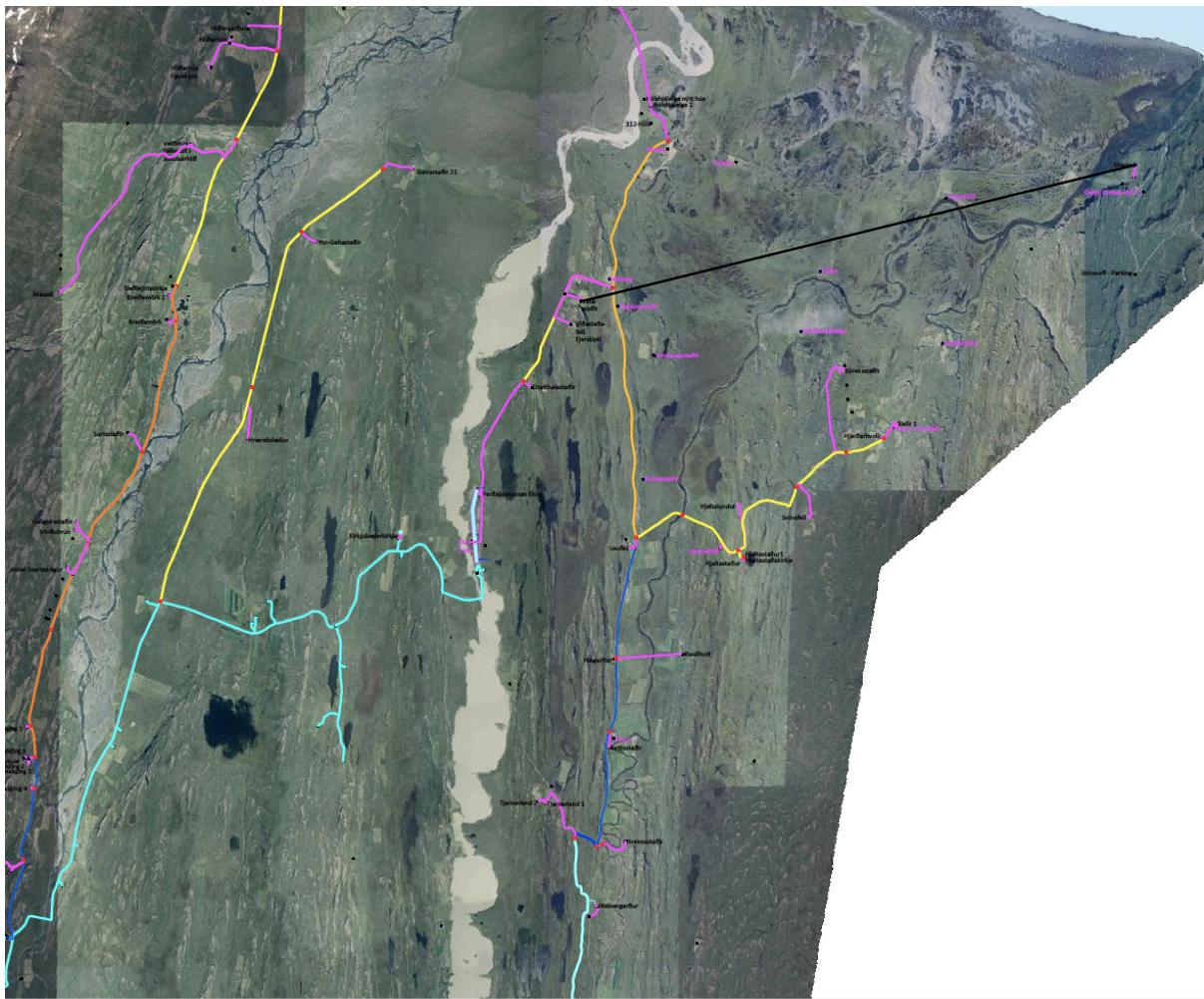
Mynd 1. Fyrstu drög áætlun plægingarleiðar ljósleiðara í Skriðdal og Velli unnið út frá gögnum frá EFLU. Fyrstu hugmyndir voru að setja upp örbylgjusamband í Gagnstöð (svört lína).
